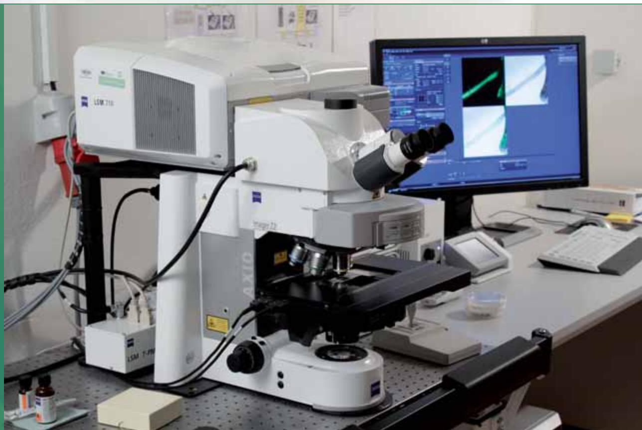
Laserový skenovací mikroskop Laser Scanning Microscope LSM 710, Carl Zeiss
